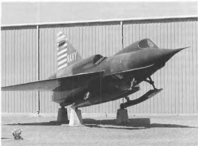
Си Дарт № 5. Эта машина так и не получила двигателей, и, следовательно, не поднималась в воздух. Машина хранится в Сэнд Поинт. Штат Вашингтон. Видны гидролыжи с колесиками, в транспортном положении, брызговики, по бортам носовой части фюзеляжа и фонарь, с клиновидным остеклением. Фото Майкл Бэлдок. Airliners.net.
